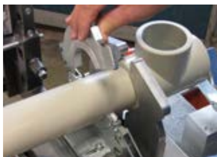
Montera rören i svetsmaskinen enligt maskinens anvisningar
