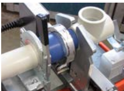
Värm upp materialet och pressa långsamt ihop delarna
